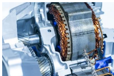
EVモーター
